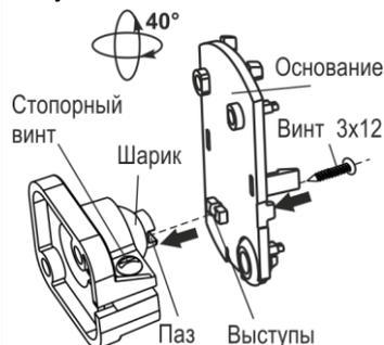
**Кронштейн обеспечивает поворот извещателя в горизонтальной и вертикальной плоскостях на 40°**
