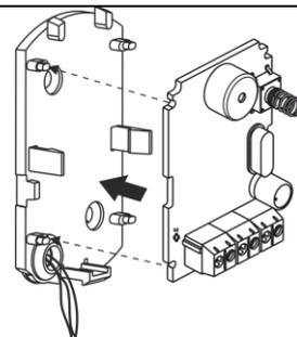
**8** Закрепить подведенные провода в клеммах извещателя
